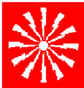
PULSANTE DI ALLARME ANTINCENDIO
